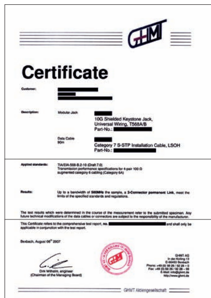
Obr. 2 Certifikát nemá žiadnu výpovednú hodnotu, keďže v teste permanentnej linky nie sú zahrnuté patch káble.
