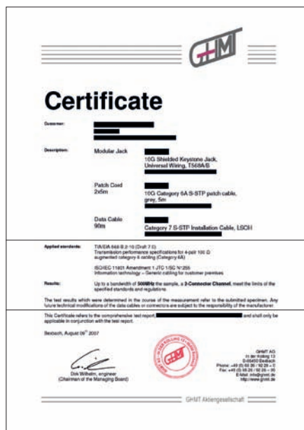
Obr. 1 Text certifikátu potvrdzuje iba pozitívny výsledok testovania šírky pásma. Zmienka o skúškach Alien Crosstalk chýba.
